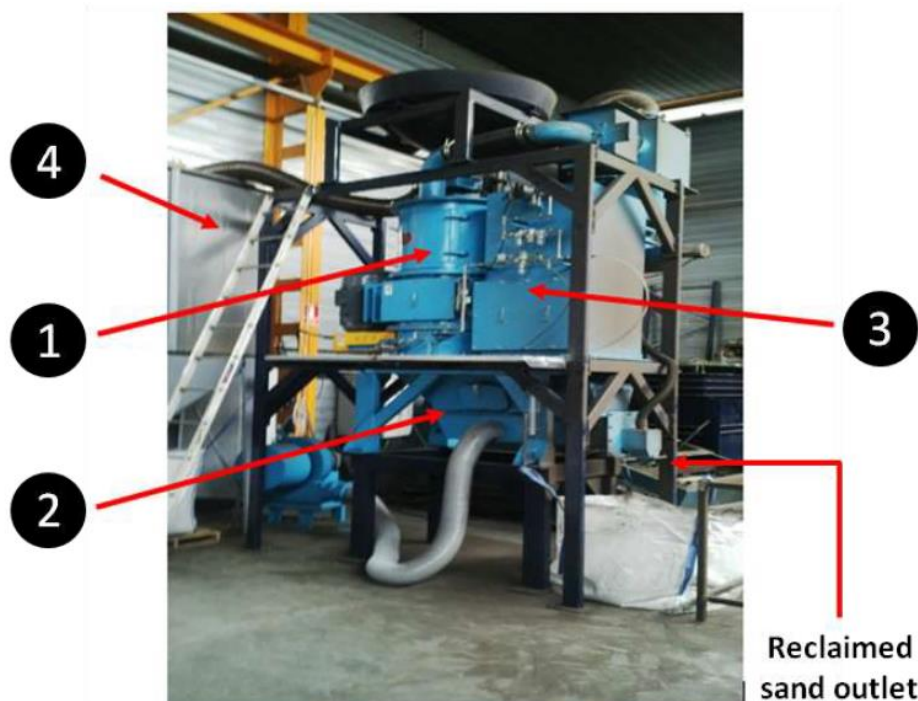
Figura 2: Componentes del regenerador de ONDARLAN: (1) cámara de atrición, (2) lecho fluidizado, (3) ciclón, (4) equipo de eliminación de partículas
